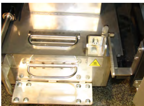
Figure 3-27 Установленный фиксатор сливного поддона
